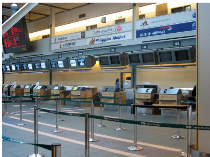
Figura 2: YVR – Balcões de Check-In rebaixados. Fonte: YVR, 2010.
